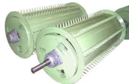
Dettaglio degli aspi apritori del Pu.La.Su.
